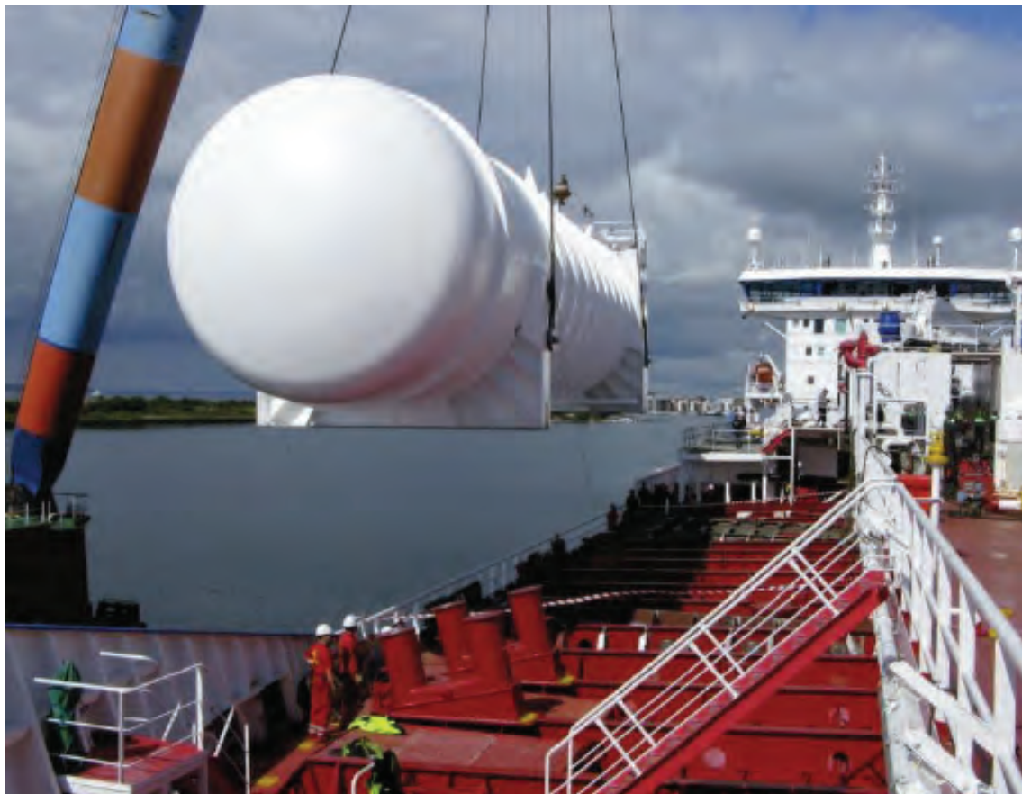
Fig. 9. The LNG tank 500m 3 for m/v Bit Viking [14]
