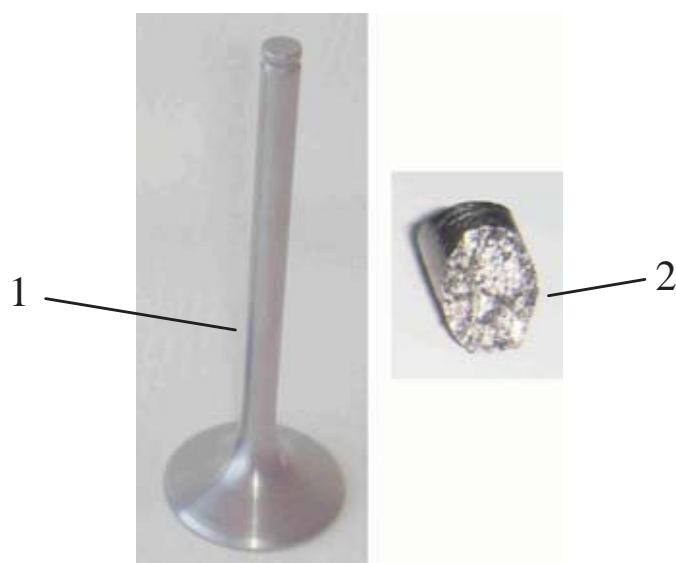
Rys. 2. Złom próbki zaworu wykonanego z TiAl6Zr4Sn2Mo2 . Powierzchnia zaworu chromowana 1 – zawór wylotowy silnika motocyklowego KTM, 2 – złom próbki zaworu po próbie ściskania
