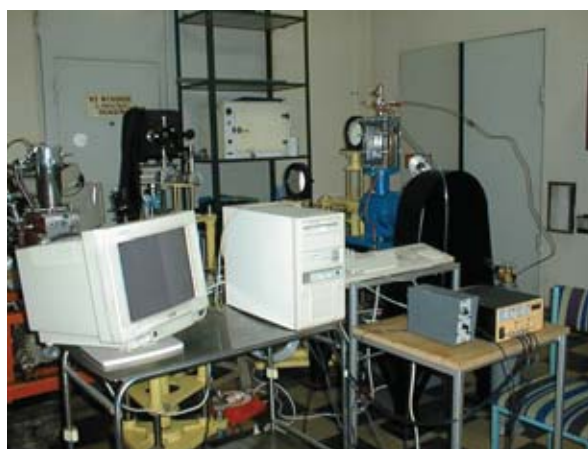
Rys. 1. Schemat i widok stanowiska badawczego MPS. 1.mechanizm korbowy, 2.cylinder roboczy, 3. tłok, 4.komora spalania, 5. System napełniania i usuwania spalin, 6. sprzęgło elektromagnetyczne, 7. koło zamachowe, 8 przekładnia pasowa, 9. silnik elektryczny, 10. butla gazowa, 11. pompa próżniowa, 12. świeca zapłonowa, 13. układ zapłonowy, 14.piezoelektryczny czujnik ciśnienia, 15.wzmacniacz, 16.impulsator, 17. indiskop 427, 18. Sterownik systemu optycznego, 19. Karta pomiarowa, 20. Komputer PC
