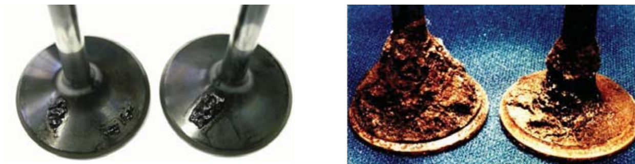
Fot. 4. Zawory dolotowe jako silnikowe elementy testowe (CEC F-05-93) Fig. 4. Intake valves as an engine test components (CEC F-05-93)
