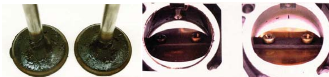
Fot. 2. Silnikowe elementy testowe oceniane zgodnie z procedurą CEC F-04-87 Fig. 2. Engine test components evaluates according to CEC F-04-87 procedure
