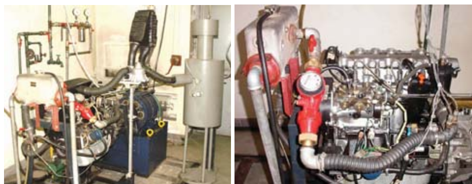
Fot. 8. Stanowisko testowe z silnikiem PSA XUD9 A/L [ITN] Fig. 8. View of test bed with PSA XUD9 A/L engine [ITN]
