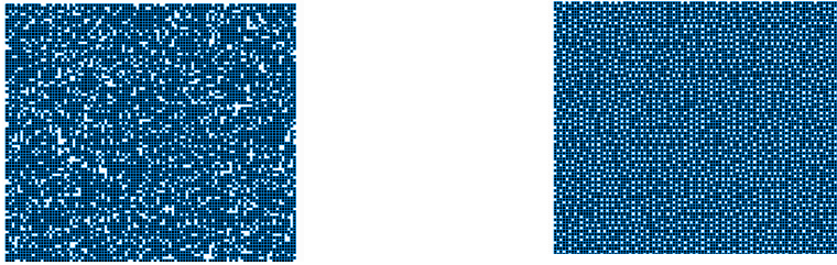
Rys. 1. Mikromechaniczne modele do wyznaczania efektywnych własności materiałów porowatych – porowatość 20% z efektem łączenia się porów (a), bez łączenia się porów
