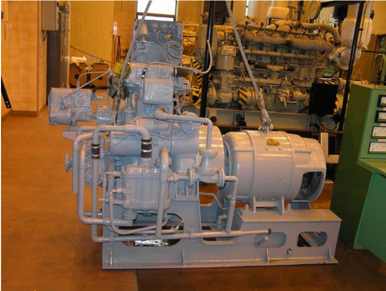
Rys. 3 Silnik po próbach gotowy do montażu na stanowisku w laboratorium Fig. 3 Engine after tests in shipyard prepare to fix on laboratory test bed
