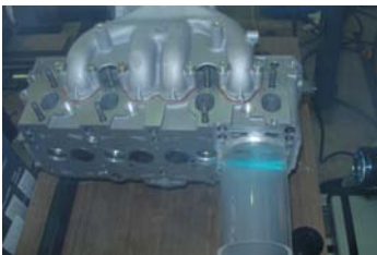
Rys. 4. Stanowisko do pomiaru rozkładu prędkości w cylindrze Fig. 4. Measuring position distribution of velocity in cylinder
