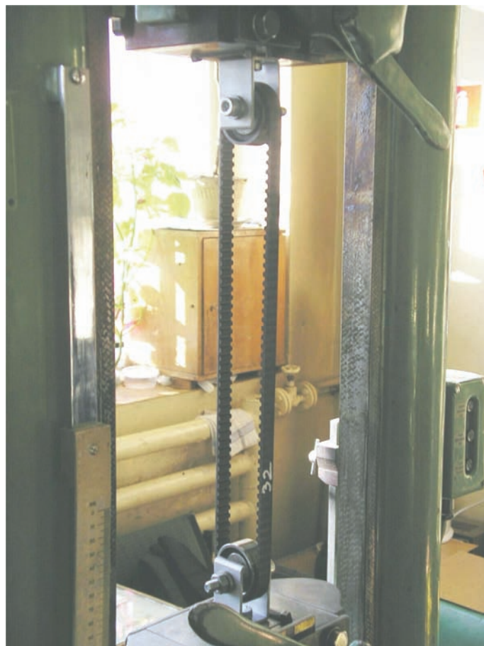
Rys. 1. Pasek zamocowany w maszynie wytrzymałościowej za pośrednictwem uchwytów wykonanych z rolek napinaczy
