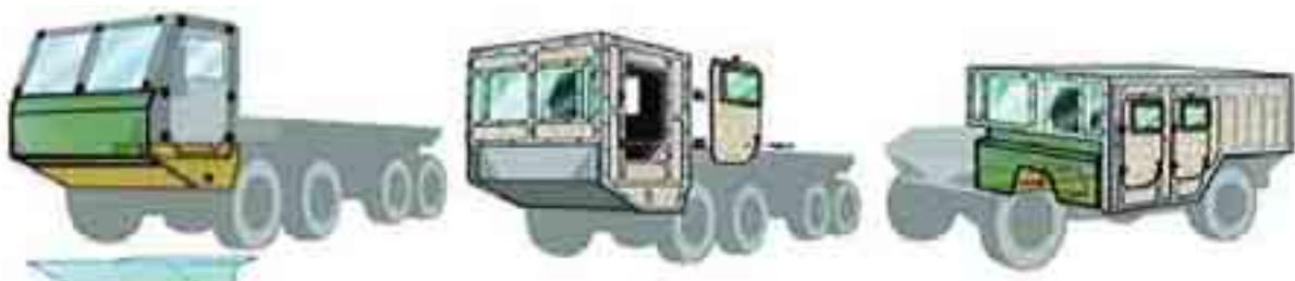
Fig. 5. Modular armour FlexKit (Ceradyne Inc. USA)
