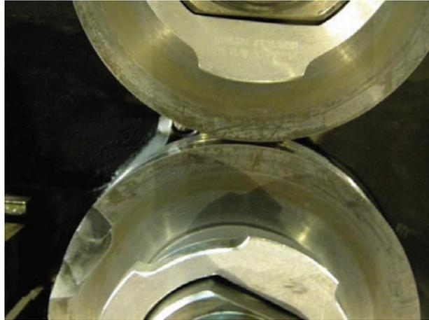
Fig. 11. Broken carbide ring
