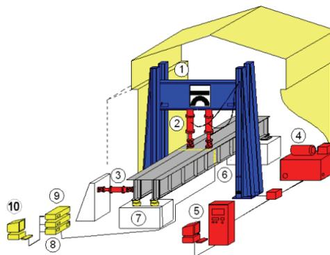
Fig. 2. Diagram of „Stend” stand for testing bridge spans
